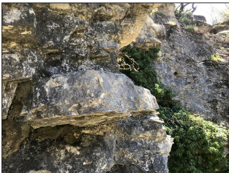
Foto 7-8-9: esempi di porzioni rocciose in affioramento passibili di distacco
